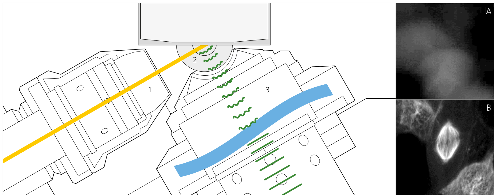
带有激发物镜（1）、半月形透镜（2）和含自由波前光学器件的检测物镜（3）的样品夹和核心光学模块示意图。示例显示了没有（A）和带有折射率校正（B）的成像。
